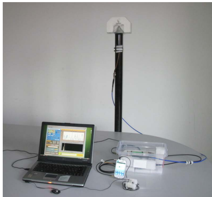
Figura 10 Set-up sperimentale per la misura di potenza emessa da telefoni cellulari
