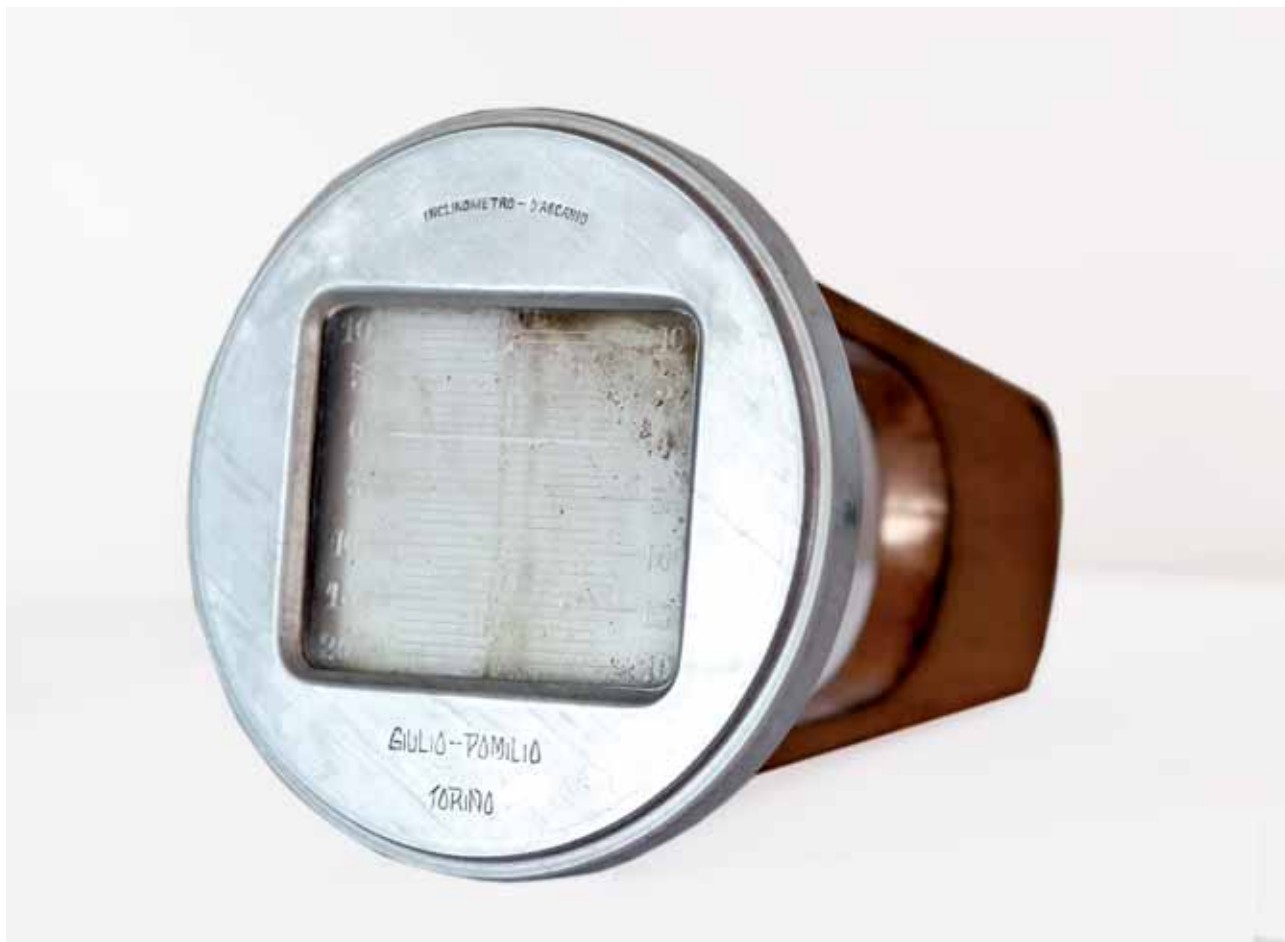
Inclinometro universale per aereo inventato nel 1916 dall'ingegner Corradino d'Ascanio e costruito da Giulio Pomilio di Torino, usato per controllare gli assetti di volo in salita, in discesa e in assenza di visibilità.
