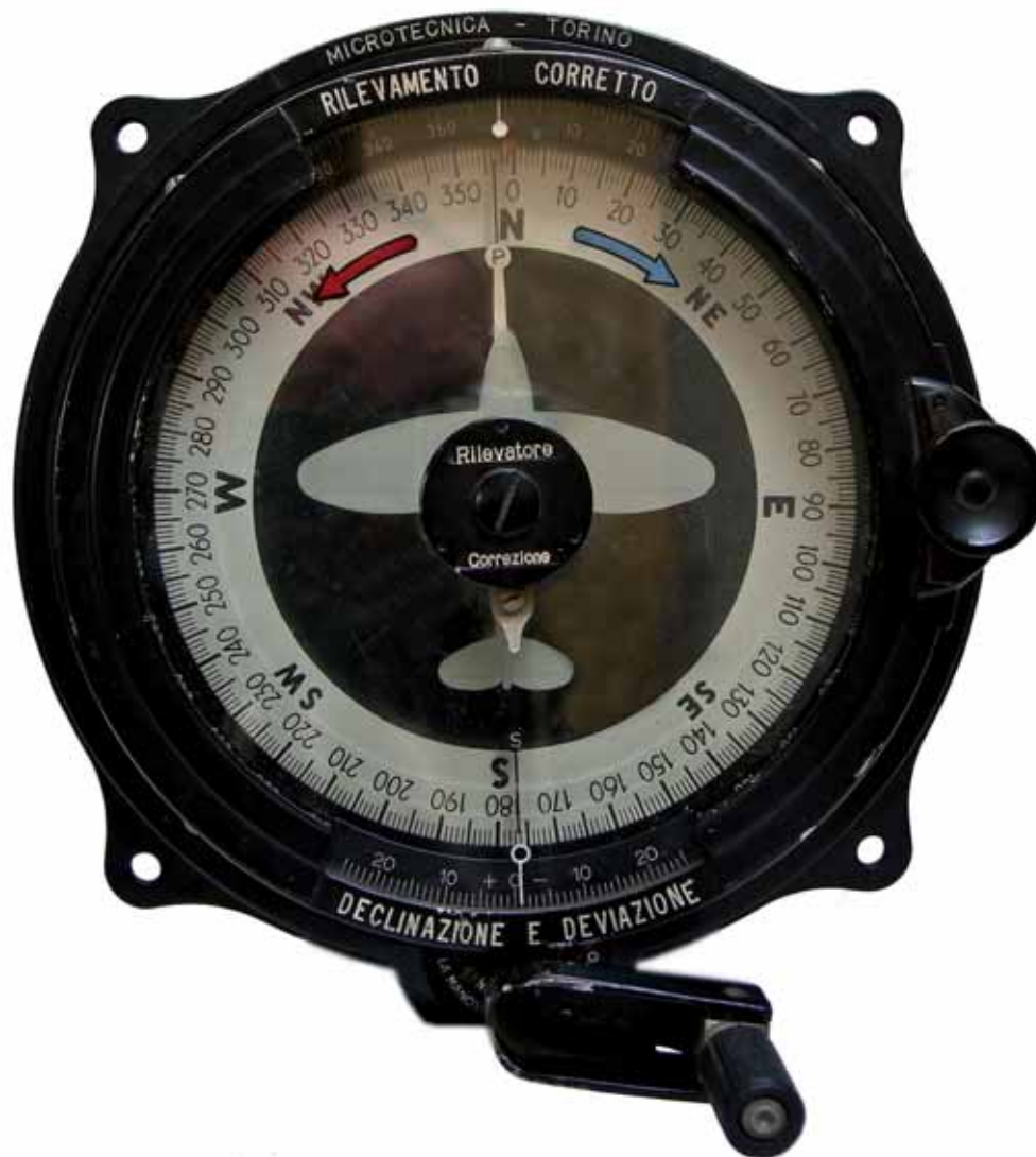
Strumento di bordo: ripetitrice marconista mtb/r costruita dalla Microtecnica di Torino su licenza della tedesca Patin.
