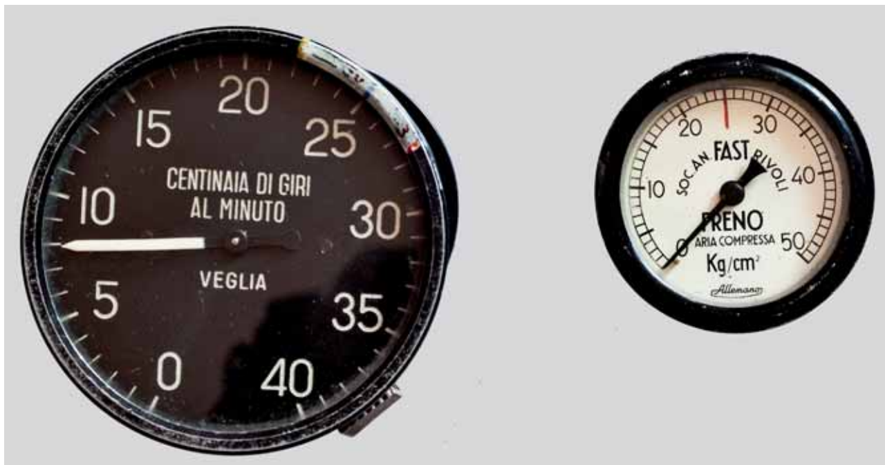
Strumenti di bordo: contagiri per motore dell'azienda Veglia e manometro pressione aria compressa per freno della Società Fast di Rivoli.
