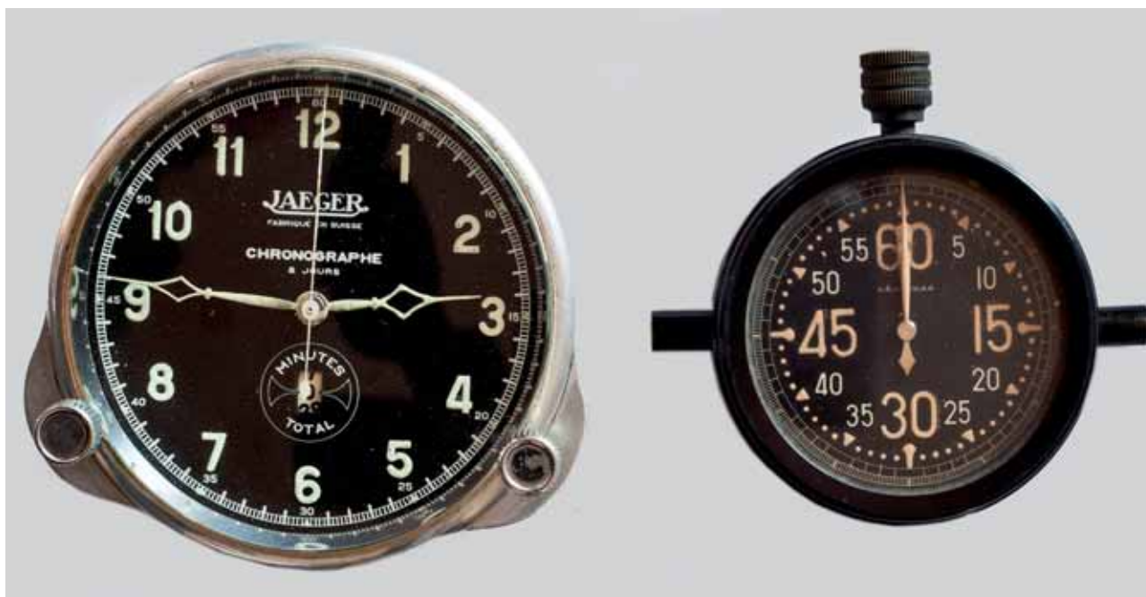
Strumenti di bordo: orologio con cronometro Jaeger e cronometro Leonidas modello 1-852 usato come sganciabombe per misurare lo sgancio tra una bomba e l'altra. Veniva applicato anche sulla cloche dei bombardieri P108.
